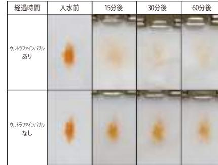
ウルトラファインバブルの有無による油分の汚れ落ち比較（第三者機関調べ）
