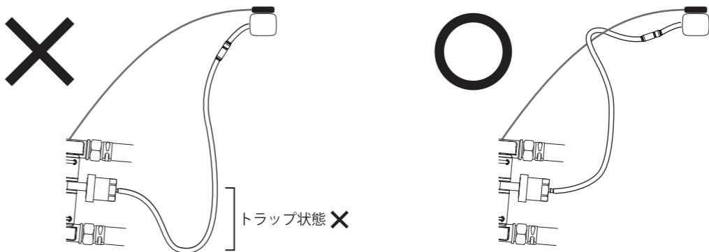
**△ 吸気配管は樹脂ボディに向けて下り勾配がつくように設置してください。**
