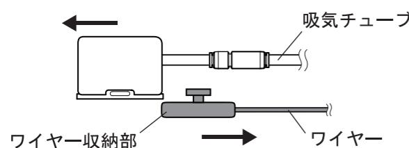
③ 吸気チューブから吸気ユニット(逆止弁付き)を取り外す。
