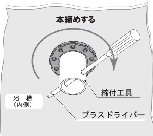
底付き穴が真上にくるように微調整をする。
